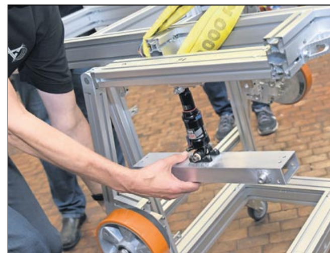
Fahrgestell: Räder werden nur zur Anschubphase gebraucht. Sobald das Pod Tempo aufgenommen hat, werden sie hochgefahren. Das Pod „fliegt“ mittels Magneten.
