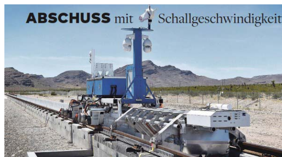
Auf einer Teststrecke in Nevada wurde die Beschleunigung der Hyperpods noch ohne Röhre getestet
