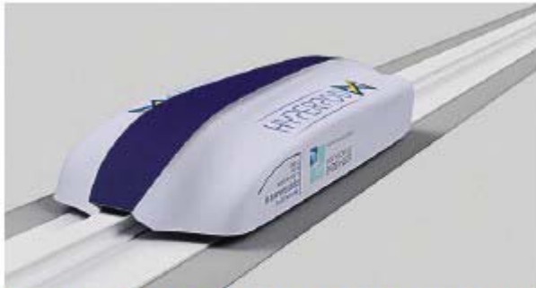
Der Hyperpod-X (L) der Oldenburger verzichtet im Gegensatz zum Münchener Vehikel auf eine Turbine an der Spitze. Sie soll die verbleibende Luft in der Röhre effektiv am Hyperpod vorbeileiten
